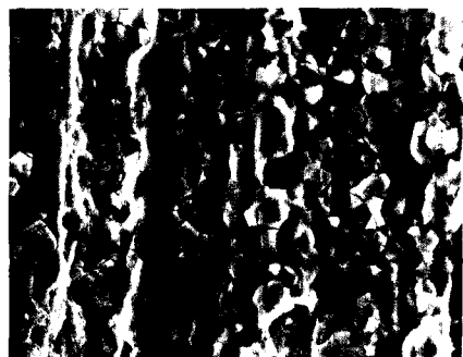
图11 开裂平面腐蚀产物形貌
